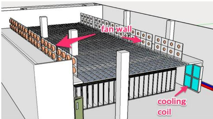
Wall Type Build-in Cooling 시스템
